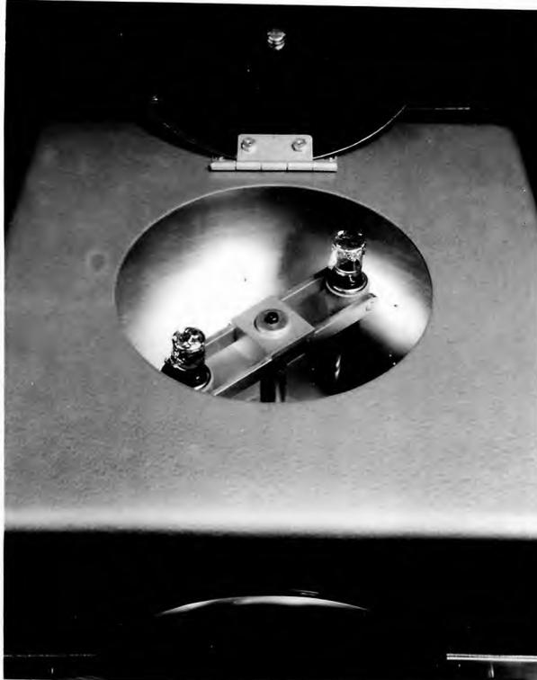
FIGURE 5. CENTRIFUGE TUBES
